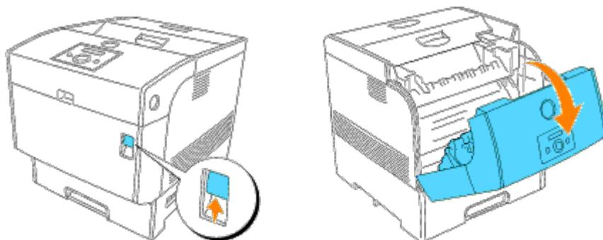
2. Pulse el botón como se indica en la siguiente ilustración y abra la cubierta del tambor de imagen.
