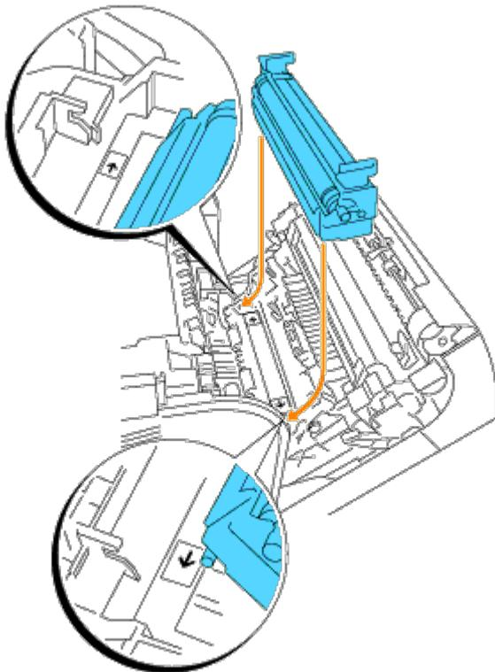
7. Para inmovilizar el rodillo de transferencia en la impresora, baje las lengüetas hasta que oiga un chasquido.
