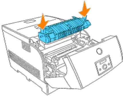
2. Sujetando las asas a ambos extremos del cartucho de fusor, inserte el cartucho de fusor por completo hasta que las palancas junto a ambos extremos del cartucho vuelvan a su posición original.
