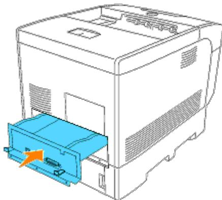
7. Apriete los tres tornillos de la tarjeta del controlador en la parte posterior de la impresora.
