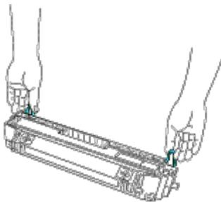
4. Alinee las marcas de flecha en el rodillo de transferencia con las marcas en la impresora e introduzca con cuidado el rodillo en la impresora.
