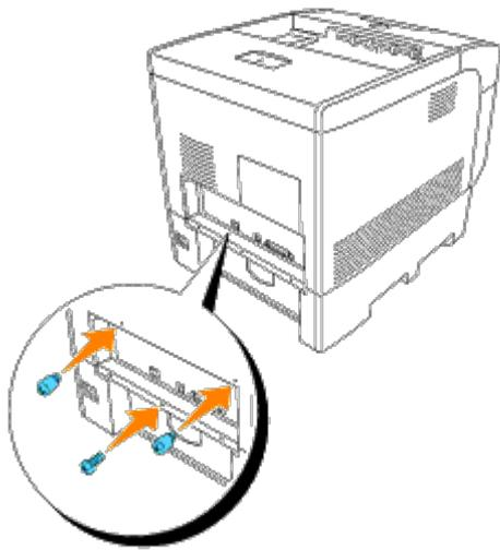
8. Vuelva a colocar la cubierta de la bandeja de papel en la parte posterior de la impresora.
