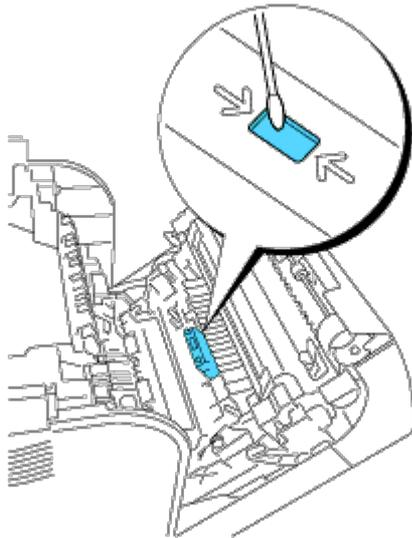
**✍ NOTA:** No permita que nada duro entre en contacto con la ventana del sensor de control de densidad automático (CTD). No ejerza demasiada fuerza al limpiar la ventana.
