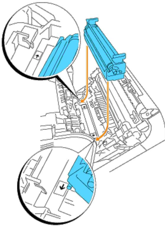
3. Para fijar el cartucho de Rodillo de Tasferencia en la impresora, baje las lengüetas hasta que oiga un chasquido.
