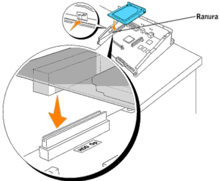
6. Alinee las dos protuberancias con los agujeros de la tarjeta del controlador y luego apriete los dos tornillos en la parte posterior de la tabla del controlador.
