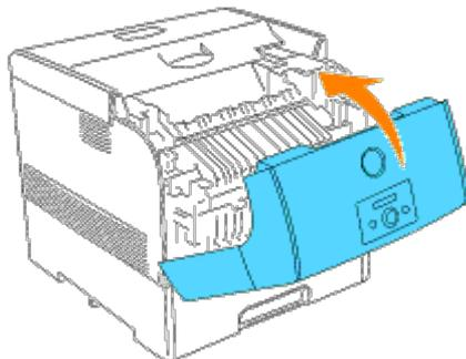
5. Si se muestra un mensaje de atasco de papel, levante el pestillo frontal y abra la cubierta frontal del todo.
