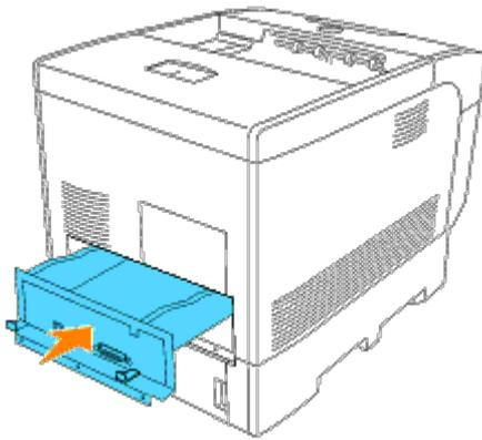
8. Apriete los tres tornillos de la tarjeta del controlador en la parte posterior de la impresora. Los dos tornillos de la parte superior tienen una forma distinta al de la parte inferior. Preste atención para no confundirlos.
