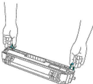
6. Haga coincidir las marcas de flecha en el rodillo de tasferencia con las marcas en la impresora y empuje el rodillo con cuidado para insertarlo en la impresora.
