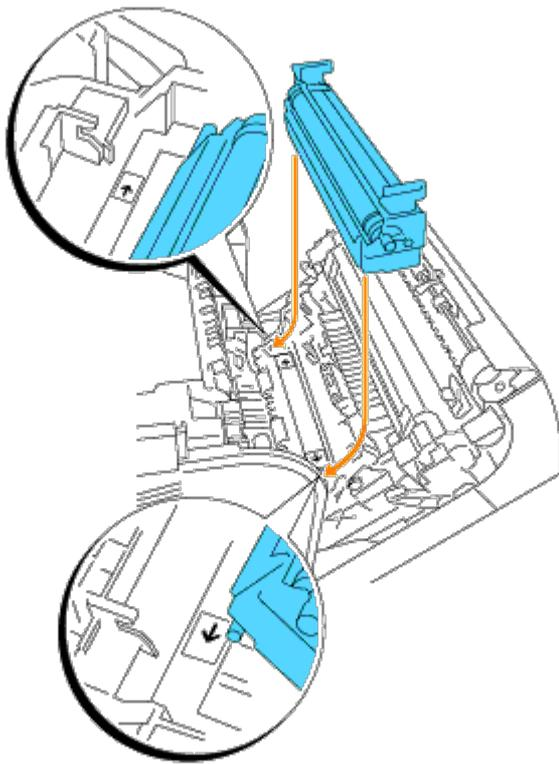
7. Para fijar el cartucho de Rodillo de Tasferencia en la impresora, baje las lengüetas hasta que oiga un chasquido.
