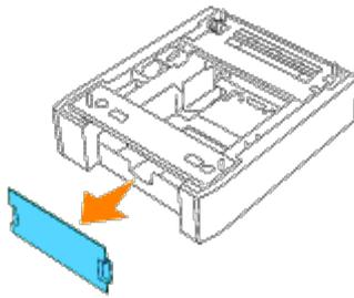
4. Con cuidado, extraiga la bandeja del módulo de bandeja de 500-hojas opcional hasta que se detenga. Sujetando la bandeja con ambas manos, levante la parte frontal ligeramente y retire la bandeja del módulo de bandeja.
