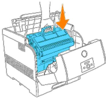
➡ **AVISO:** Si al bajar el cartucho para insertarlo en la impresora no alinea los rodillos con las ranuras correctamente, podría dañar el cartucho.
