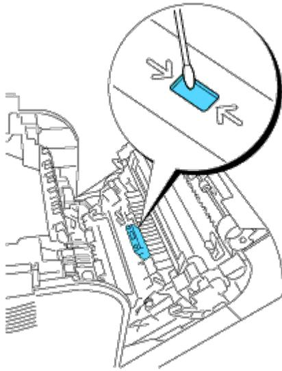
**NOTA:** no permita que ningún objeto duro entre en contacto con la ventana del sensor del control automático de densidad (CTD). No ejerza demasiada fuerza al limpiar la ventana.
