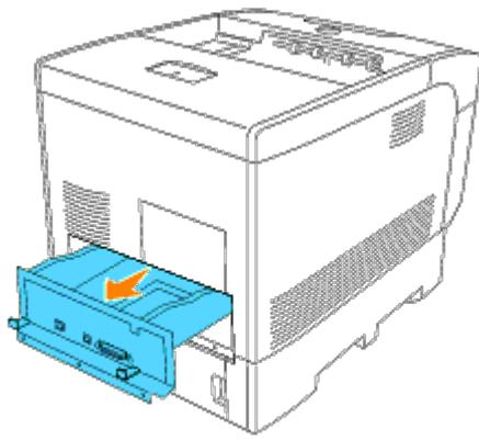
5. Vuelva a colocar los dos tornillos de la parte posterior de la tarjeta del controlador.
