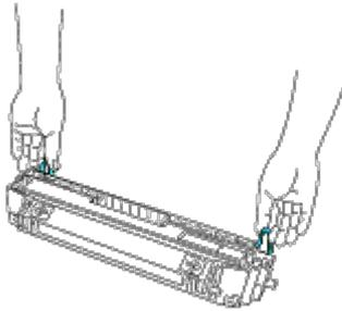
6. Alinee las marcas de flecha en el rodillo de transferencia con las marcas en la impresora e introduzca con cuidado el rodillo en la impresora.
