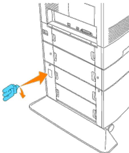
14. Enchufe el cable de alimentación al conector del cable de alimentación situado en la parte posterior de la impresora, enrolle el cable en el gancho del cable como se indica en el gráfico y tire del cable ligeramente. A continuación, conecte el otro extremo del cable al enchufe con toma de tierra.
