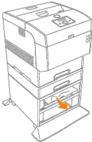
4. Levante el pestillo frontal y abra la cubierta frontal del todo. Confirme que no queden restos de papel dentro de la impresora.
