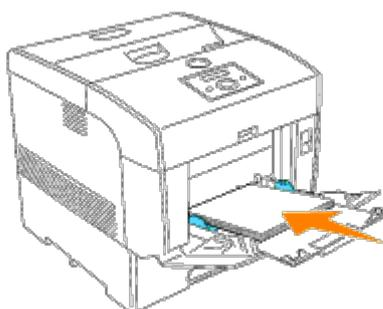
4. Deslice las guías de anchura hasta que toquen ligeramente el borde de la pila de material de impresión.
