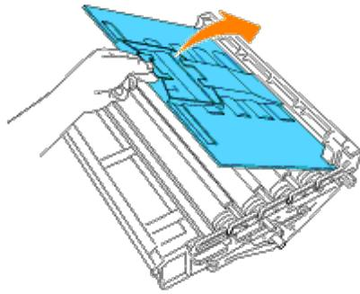
4. Sujetando el tambor de imagen por el asa, con la parte plana mirando hacia la parte posterior de la impresora, alinee las guías de plástico a ambos lados del tambor de imagen con las ranuras que hay delante de las flechas en la impresora.
