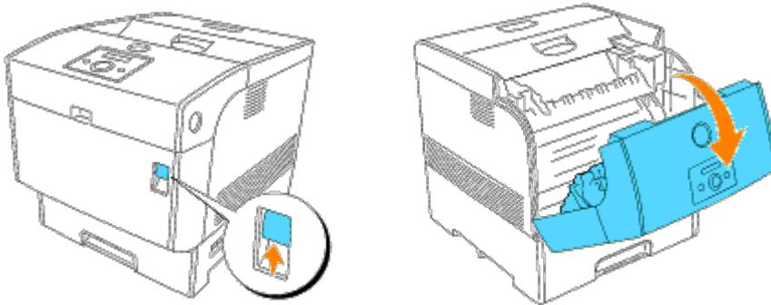
2. Pulse el botón como se indica en la siguiente ilustración y abra la cubierta del tambor de imagen.
