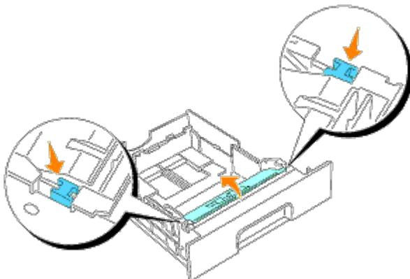
3. Levante el mecanismo del rodillo separador y deslícelo hacia la izquierda.
