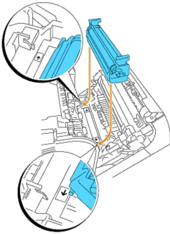
5. Para inmovilizar el rodillo de transferencia en la impresora, baje las lengüetas hasta que oiga un chasquido.
