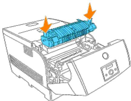
6. Sujetando el fusor por las asas que tiene a ambos extremos, insértelo del todo hasta que las palancas situadas junto a los extremos vuelvan a su posición original.
