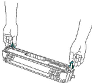
2. Haga coincidir las marcas de flecha en el rodillo de tasferencia con las marcas en la impresora y empuje el rodillo con cuidado para insertarlo en la impresora.
