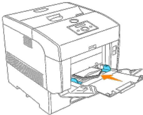
Para cargar sobres de menos de 8.66" (220 mm) de ancho en el alimentador multiuso, inserte los sobres con las solapas cerradas y hacia la parte derecha, o bien con las solapas abiertas y hacia la parte de atrás. Para cargar sobres de más de 8.66" (220 mm) de ancho en el alimentador multiuso, inserte los sobres con las solapas cerradas y el borde corto hacia la impresora. La cara de impresión debe estar boca abajo. Se pueden cargar sobres de una vez hasta la línea de llenado máximo de la bandeja.
