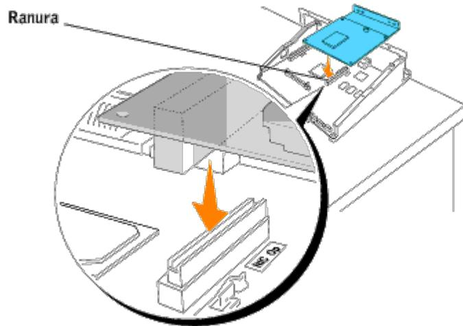
6. Alinee las dos protuberancias con los agujeros de la tarjeta del controlador y luego apriete los dos tornillos en la parte posterior de la tabla del controlador.
