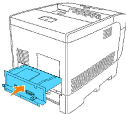
8. Retire la cubierta de la bandeja de papel de la parte posterior de la impresora.
