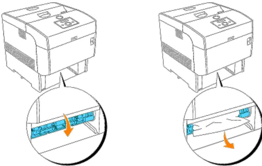
5. Levante el pestillo frontal y abra la cubierta frontal del todo. Confirme que no queden restos de papel dentro de la impresora.
