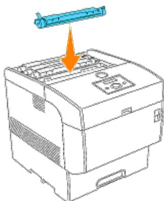
4. Agarre con los dedos las palancas a cada extremo del cartucho de tóner y empuje hacia abajo con fuerza para girar las palancas hacia delante.
