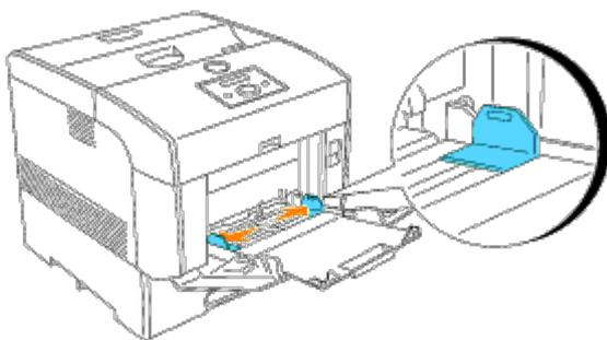
3. Inserte el material cara abajo y el borde superior primero en el alimentador multiuso.
