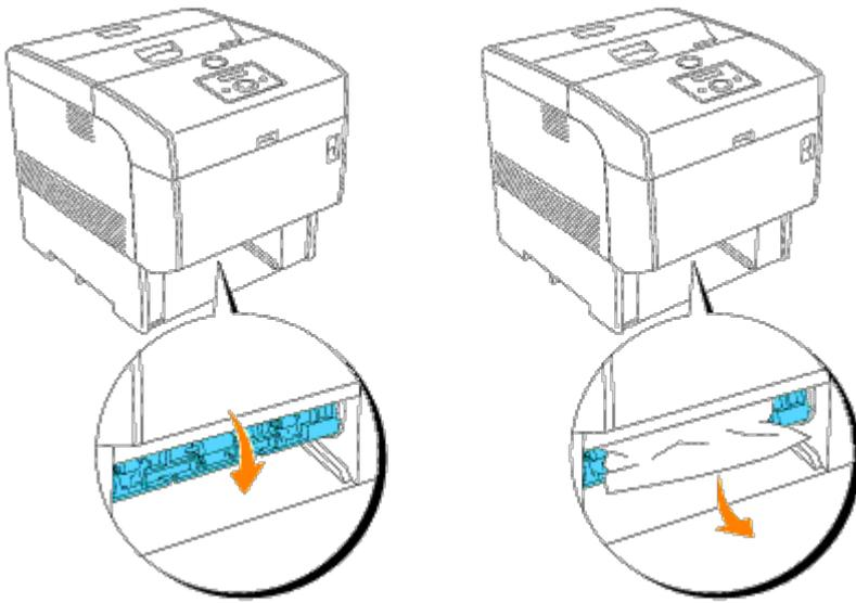
12. Levante el pestillo frontal y abra la cubierta frontal del todo. Confirme que no queden restos de papel dentro de la impresora.
