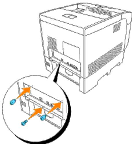
9. Vuelva a colocar la cubierta de la bandeja de papel en la parte posterior de la impresora.
