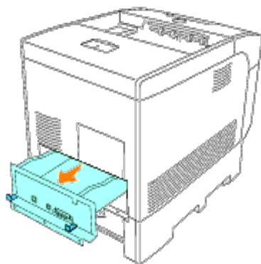
5. Vuelva a colocar los dos tornillos de la parte posterior de la tarjeta del controlador.
