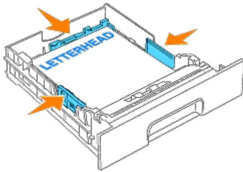
7. Inserte la bandeja en la impresora y empújela hacia dentro hasta que se detenga.
