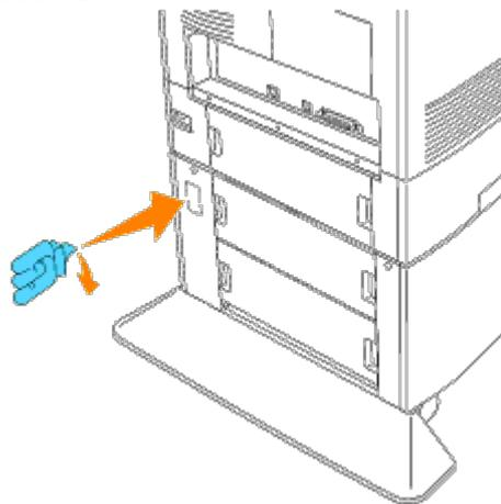
10. Enchufe el cable de alimentación al conector del cable de alimentación situado en la parte posterior de la impresora, enrolle el cable en el gancho del cable como se indica en el gráfico y tire del cable ligeramente. A continuación, conecte el otro extremo del cable al enchufe con toma de tierra.
